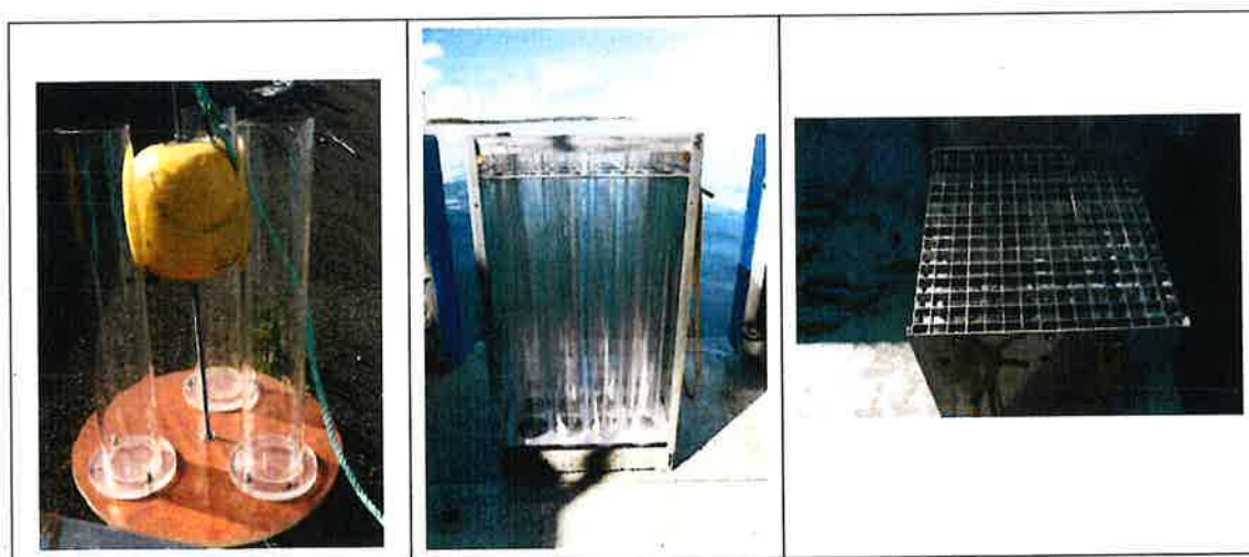
Figur 1 Eksempel på utforming av sedimentfeller. Bildet til venstre viser standard sedimentfelle som plasseres på bunnen eller i vannsøylen. Bildet i midten viser større sedimentfeller for plassering på bunnen og detalj som viser åpning med strømdemper er vist i bildet til høyre.
