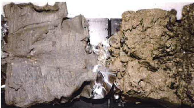
Figur 5: Bilde fra sylindrerprøver dybde 1,2-1,6m. Materialet er grusig sand samt bløt leire fra 1,4m dybde.
