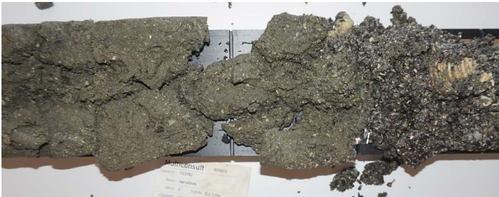
Figur 4: Bilde fra sylindrerprøver. Materialet er grusig sand fra 0,2-1,0 m dybde.
