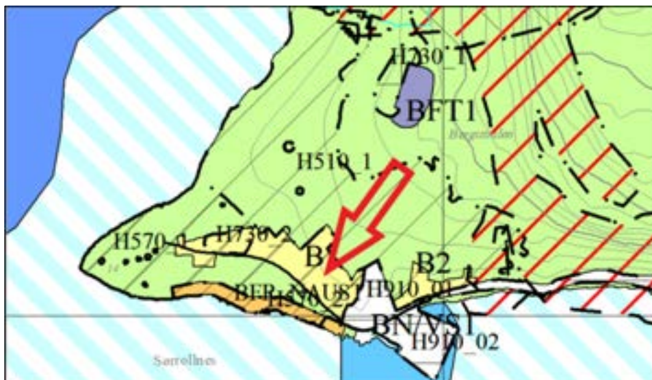
Tiltakets plassering ift. gjeldende plan. Gul flate viser areal avsatt til boligbebyggelse. Grønn flate viser LNF-område, skravur over begge flater viser hensynssone for landbruk.
